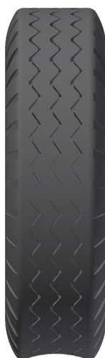
Falta de pressão
